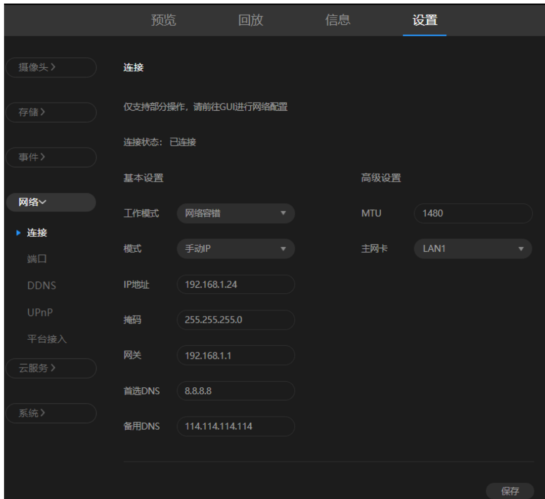
图 5-22 设置 - 网络 - 连接 - 容错模式
